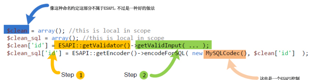
图 1: ESAPI 的工作原理介绍
